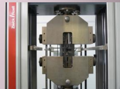
Универсальная испытательная машина (Zwick Z250)
